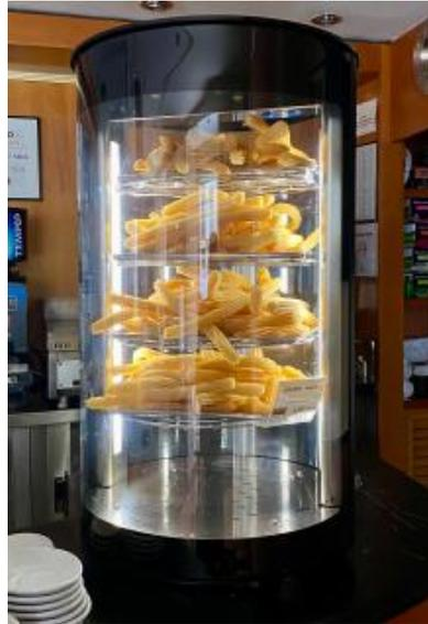
Adquisición en instalación de Vitrina estanca de calor seco ventilado para el mantenimiento de los productos de bollería y churros en caliente en una cafetería. Este equipo permite mantener unas condiciones estables de temperatura y humedad, conservando el producto en perfecto. Su diseño optimiza el consumo energético, debido a la iluminación eficiente por led y la imposibilidad de que escape el calor.
